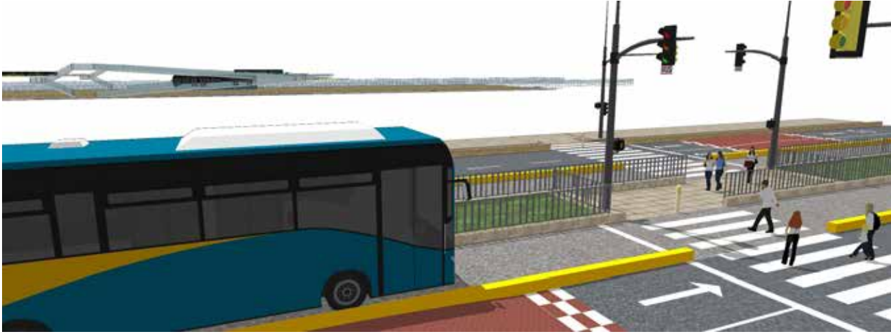
Şekil 10 Parçalı Orta Blok Geçişi (Otobüs Hatlarında Yol Güvenliği Kılavuzu, EMBARQ Türkiye, 2015)
