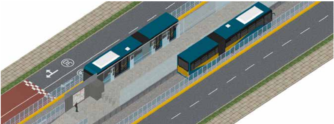
Şekil 82 Orta Şeritli BRT Koridoru İçin Yüksek Platformlu Kapalı Durak Tasarımı (EMBARQ Türkiye, 2012)
