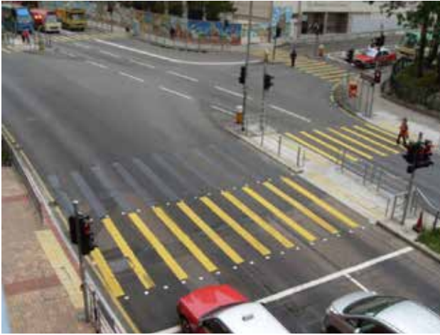
Şekil 9 Parçalı Orta Blok Geçişi (Otobüs Hatlarında Yol Güvenliği Kılavuzu, EMBARQ Türkiye, 2015)
