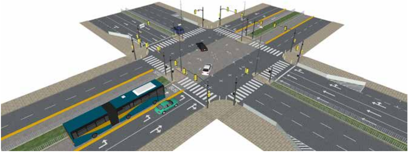
Şekil 81 Orta Şerit BRT Koridoru İçin Sola Dönüslere İzin Veren Kavşak Tasarımı (EMBARQ Türkiye, 2012)
