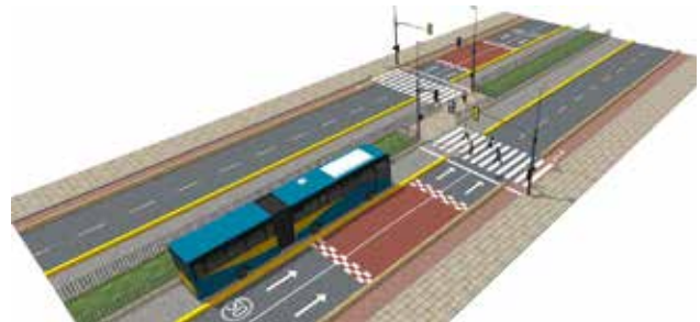
Şekil 78 Orta Şeritli BRT Koridoru İçin Yol Kesimi Parçalı Orta Blok Geçiş Tasarımı (EMBARQ Türkiye, 2012)
