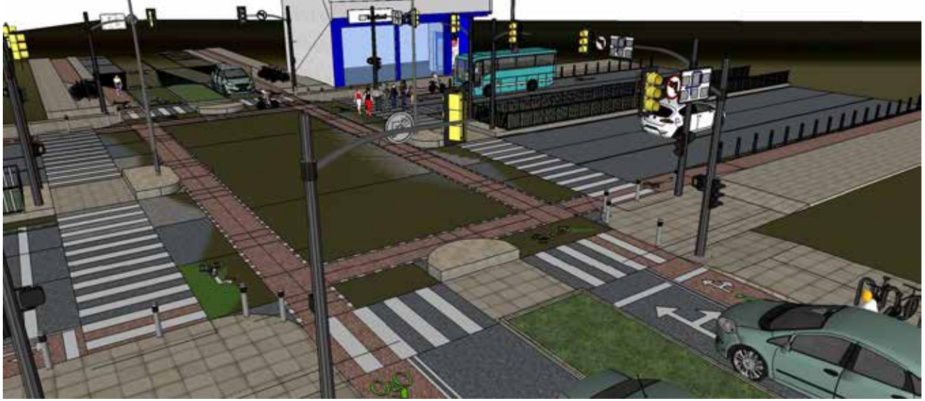
Şekil 89 İstasyon Caddesi üzerinden D-100 Karayolu'nun Edirne istikametindeki trafik akımı için güvenli bisiklet altyapısına sahip tasarım
