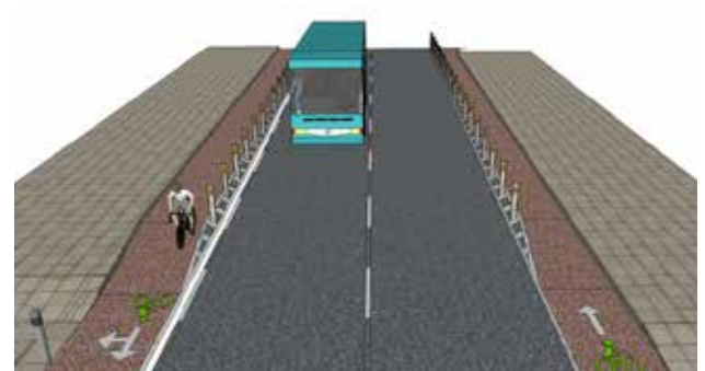
Şekil 110 Sakızlıköy Caddesi için güvenli bisiklet altyapısı kavramsal tasarım örneği
