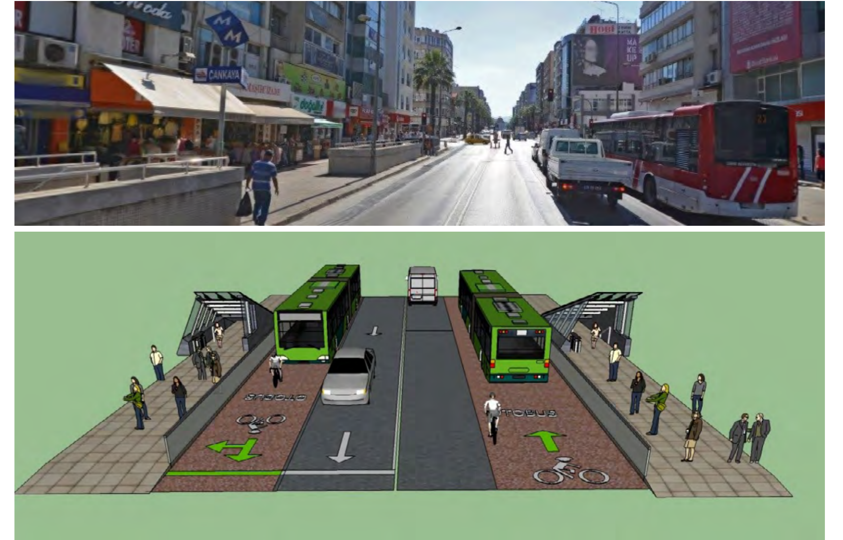
Şekil 17 | Fevzi Paşa Bulvarı'nın Çankaya Kavşağı Yaklaşımındaki Yol Platformu için Otobüs-Bisiklet Paylaşımlı Şerit Uygulamasına Ait Kavramsal Tasarım
