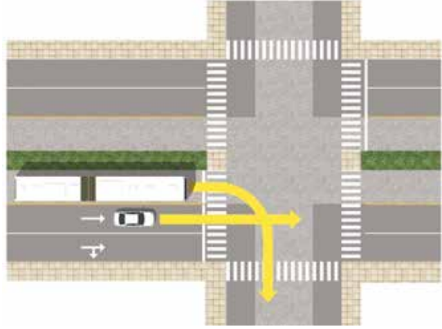
Şekil 73 Sağa dönen otobüsler ve düz devam eden diğer araçlar arasında meydana gelebilecek bir kaza senaryosu. TransMilenio hattı üzerinde bu tür kazaların yaşandığı bildirilmektedir.
