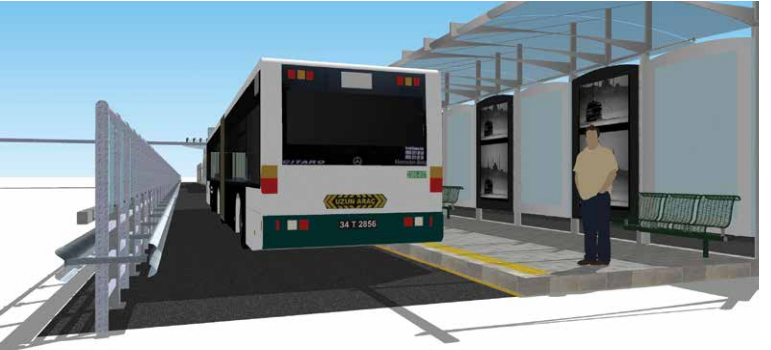
Şekil 68 Otoyol üzerinden ilerleyen metrobüsler için tavsiye edilen çift taraflı bariyer ve yüksek korkuluklar
