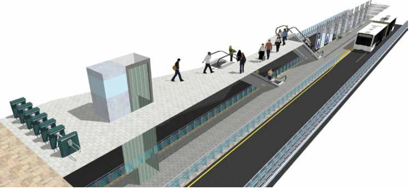
Şekil 70 Otoyolun ortasından ilerleyen metrobüs sistemlerindeki duraklarda yolcu kapasitesinin artırılması ve kalabalığın önlenmesine yönelik tasarım konsepti (bu resim yolcu girişlerini gösteren konsept bir tasarım olup tavsiye edilen tüm korkuluklar resimde gösterilmemiştir).
