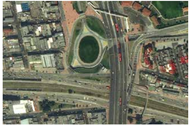
Şekil 74 TransMilenio koridoru üzerindeki üç hattın kesişim noktası: NQS, Calle 80 ve Avenida Suba. Bu üç hat arasındaki otobüs bağlantıları üstgeçitler yoluyla sağlanarak tüm dönüşlerde kapasite azami düzeyde korunuyor ve otobüsler arasındaki muhtemel anlaşmazlıklar önleniyor.
