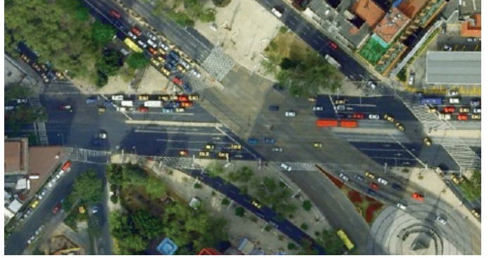
Mexico City'de Metrobüs Hattı 1 boyunca geniş ve kompleks bir kavşak. Bu tür tasarım, yukarıdaki görüntüdeki basit, dar kavşaktan daha fazla güvenlik unsuruna sahiptir. Google Earth görüntüsü.
